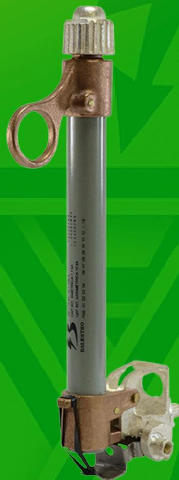
O Porta-fusível Base C é projetado para, após a operação, ficar suspenso em sua extremidade inferior, para que assim a equipe de manutenção consiga verificar a indicação de aberto da chave-fusível. O manuseio de abertura e fechamento do porta-fusível é feito com o auxílio da vara de manobra, por meio do olhal na extremidade superior da peça, quando instalada na chave-fusível.
