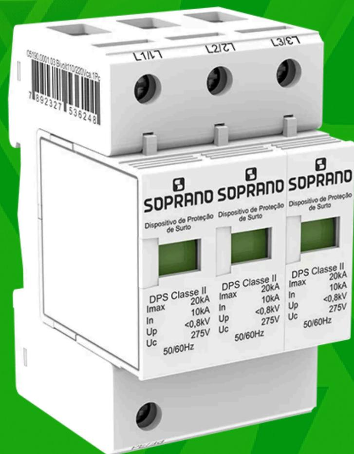
O Dispositivo de Proteção Contra Surtos (DPS) Soprano é instalado no padrão de entrada ou nos quadros de distribuição junto com os disjuntores e possuem a função de drenar à terra as correntes geradas por descargas atmosféricas, protegendo os equipamentos.
