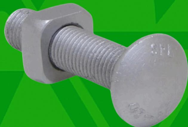
O Parafuso Francês M16 é utilizado para fixação de elementos em redes de energia elétrica. São fabricados em aço carbono e galvanizados a fogo e acompanham 1 porca quadrada m16 para instalação adequada, também são componentes essenciais para diversos produtos como cintas circulares e suportes para transformadores, viabilizando a instalação perfeita dos mesmos.
