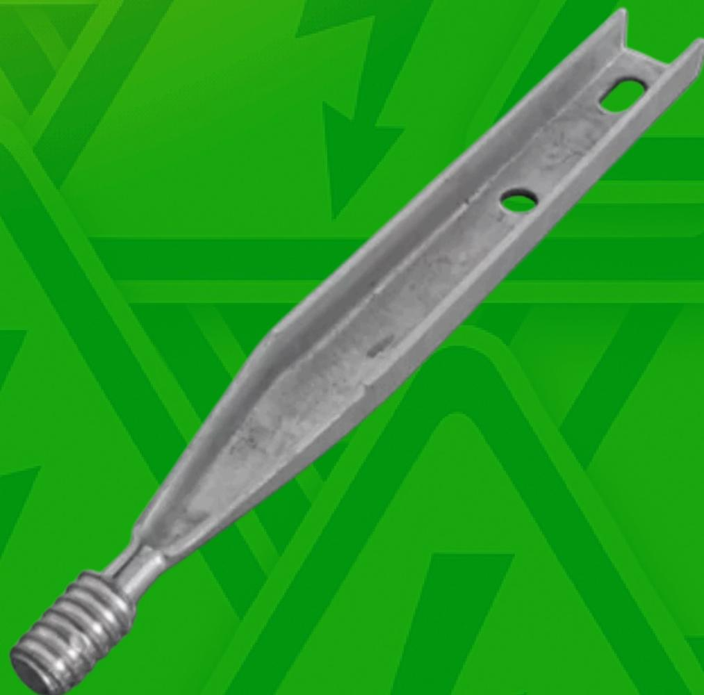
O Pino Topo cabeça de Chumbo é utilizado para fixação de isoladores tipo Pino (Hitop) - porcelana ou poliméricos - no topo do poste de energia elétrica, viabilizando o isolamento adequado das estruturas. São fabricados em aço carbono e galvanizados a fogo para garantir a resistência mecânica adequada e durabilidade da instalação.
