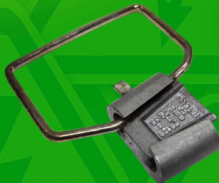
O Conector Cunha com Estribo é projetado para realizar conexão com cabos de cobre ou alumínio CA ou CAA, possibilitando a derivação de até quatro conectores tipo cunha ou a compressão. Sua aplicação é feita por efeito mola (aperto permanente). O estribo pode ser fornecido no modelo normal, lateral ou para redes protegidas. Possui alta condutividade elétrica e resistência a corrosão.
