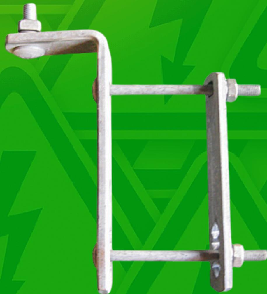
O Suporte LI serve para fixar Chaves fusíveis e Para-raios em cruzetas para redes de distribuição. Fabricado em aço carbono e revestido pelo processo de galvanização a fogo para garantir sua resistência mecânica e durabilidade.
