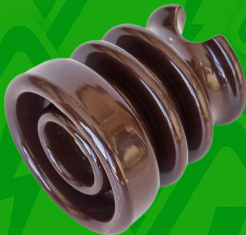
O isolador tipo pino porcelana é responsável por isolar o condutor de eletricidade de outros acessórios da instalação elétrica aérea. Em sua instalação é necessário que se utilize um laço preformado para amarrar o cabo em seu próprio corpo. Cada isolador tipo pino vem com furo roscado na parte inferior para rosqueá-lo no pino cabeça de chumbo. Neste mesmo furo possui uma massa de calafetagem, que tem a função de isolar o pino de aço do isolador.
